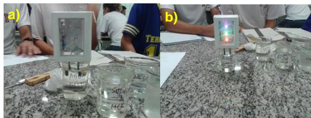
**Figura 2.** a) Teste em água destilada. b) Teste em uma solução eletrolítica forte.
