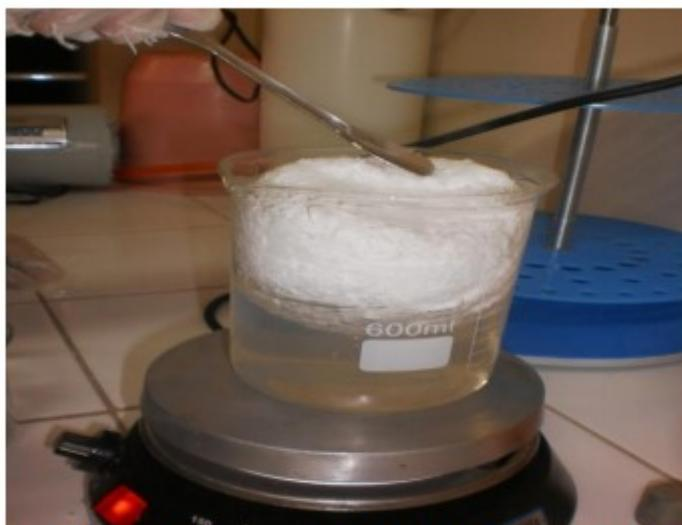
**Figura 2 – Poliestireno sendo expandido com vapor de água**
