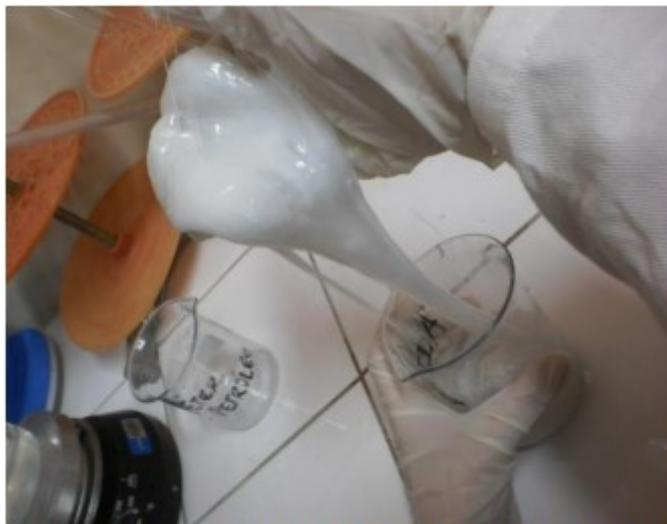
**Figura 1 – Poliestireno após colocado em acetona**
