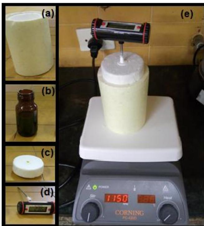
Figura 1: Materiais utilizados na construção do calorímetro (a, b, c, d). Calorímetro construído montado para realização dos experimentos (e).
