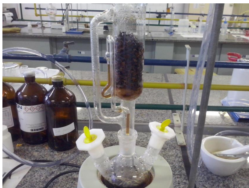
Figura 6: Extração do óleo essencial do cravo, eugenol, via Soxhlet Fonte: os próprios autores
