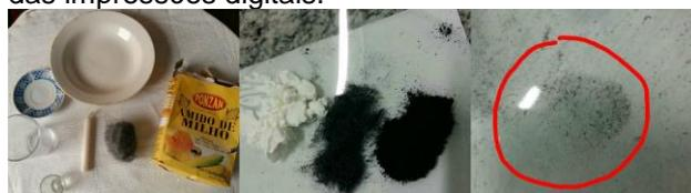
Fig. 1. Utilização da técnica do pó na revelação de impressão digital.
