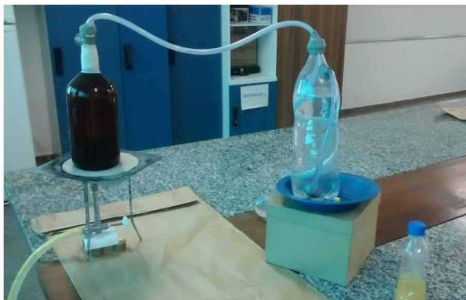
Figura 02: Destilador feito com materiais alternativos
