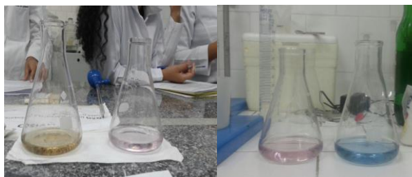
Figura 1. Pontos de viragem: Titulação de Oxirredução (Permanganimetria) à esquerda e Titulação de Complexação à direita.
