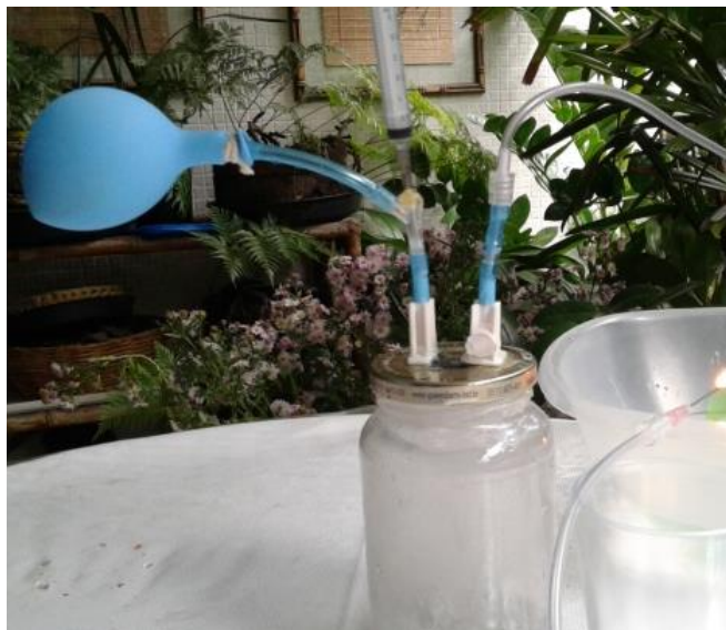
Figura 3: Gerador de gás desenvolvido para produzir acetileno.
