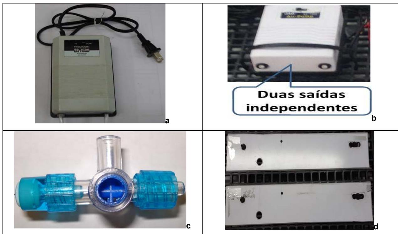
Figura 2: Aspectos Construtivos da Admissão de Amostras: a) compressor de aquário e b) detalhe de suas saídas independentes, c) válvula de três vias e d) base para suporte da válvula
