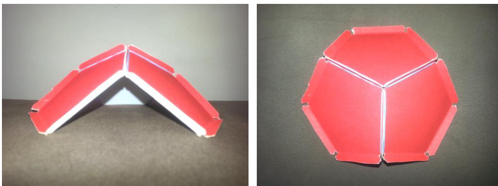
Figura 6. Demonstração da curvatura das estruturas a partir dos pentágonos.
