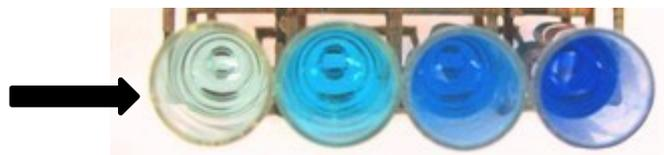
Figura 4: alteração na cor devido ao aumento do caminho ótico
