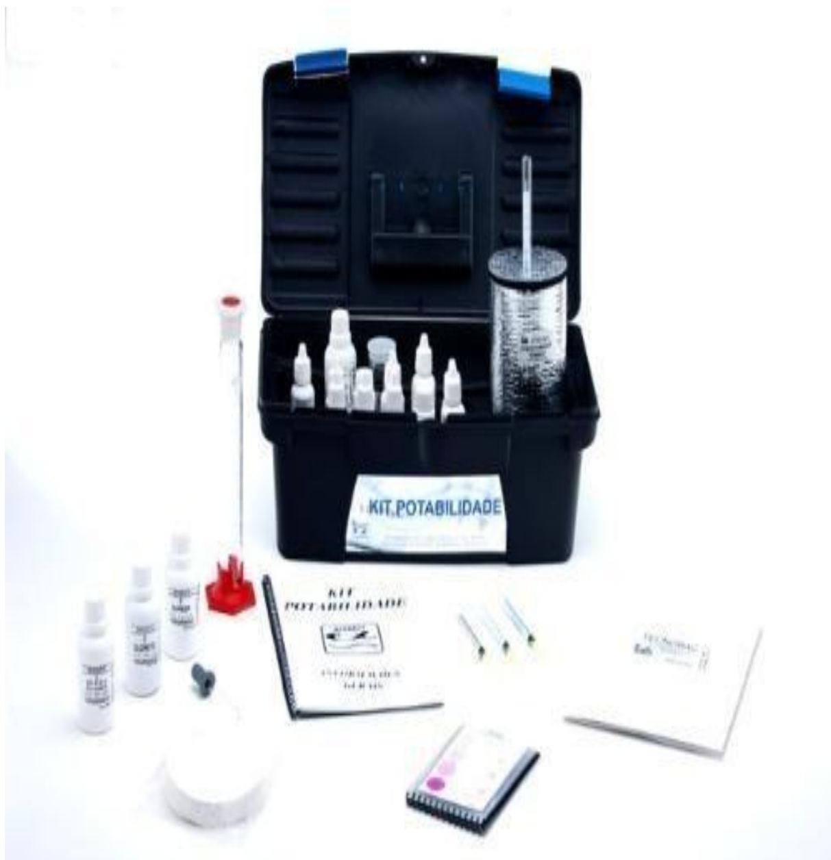
Figura 1: Kit Técnico Potabilidade Alfakit.
