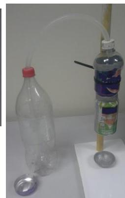
Figura 2. Destilador e condensador.
