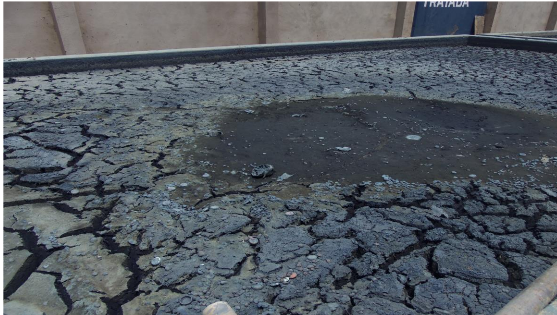
Figura 4 foto autoral: O resíduo sólido após a separação usado na produção de tijolo ecológico.
