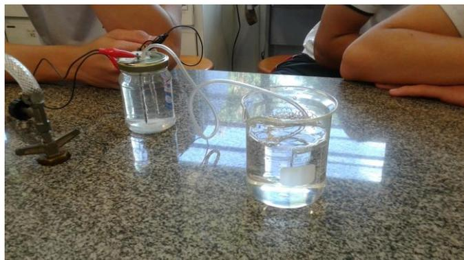
Figura 2: Sistema de eletrólise da água em funcionamento.
