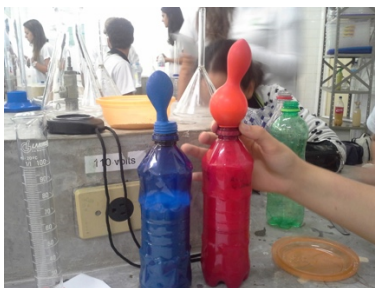
Figura 1. Esquematização das experiências realizadas para estudar a influência dos fatores de reação na velocidade de fermentação alcoólica.
