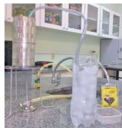
Figura 1. Esquema do experimento de baixo custo de extração por arraste à vapor.
