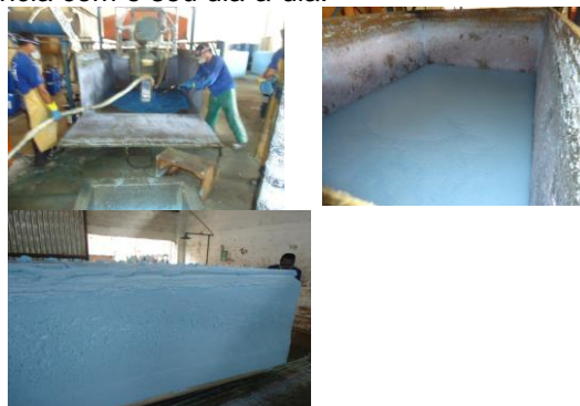
Fig 1. Processos envolvidos na produção de espumas de poliuretano.
