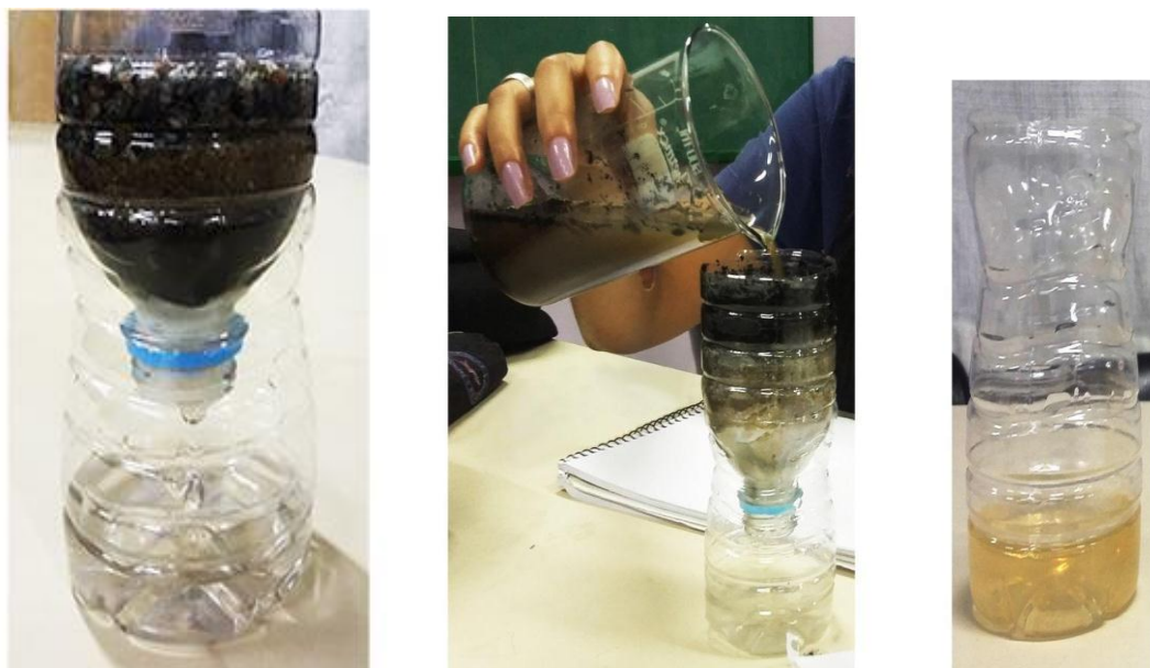
Figura 2: Filtros construídos pelos alunos e água já filtrada
