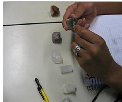
Figura 2: realização do teste de dureza
