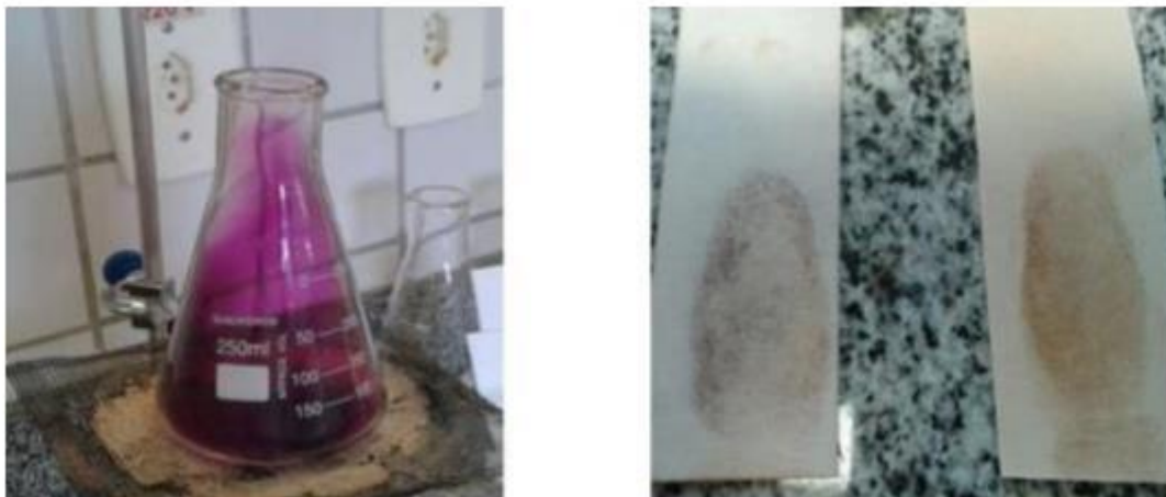
Figura 03: Cristais de iodo sendo sublimados; Revelação de impressão digital dos alunos utilizando a técnica do vapor de iodo.
