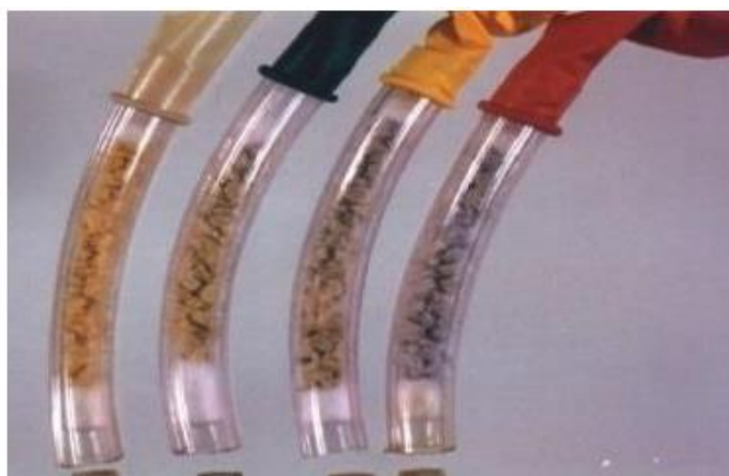
Figura 06: Montagem dos modelos demonstrativos do bafômetro após o teste com amostras de bebidas alcoólicas.
