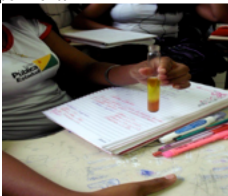
Figura 2: Após experimento, aluna com tubo de ensaio contendo uma mistura heterogênea: biodiesel na fase superior e glicerina na fase inferior.
