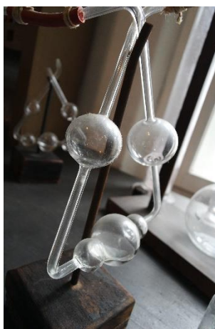
Figura 2: Fünf-Kugel-Apparat ou Kaliapparat exposto no museu Fonte: Liebig Museum - Chemiemuseum in Gießen
